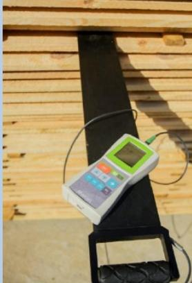
M55/56 Espada es un medidor portátil robusto de humedad para maderas que cuenta con dos sensores.
