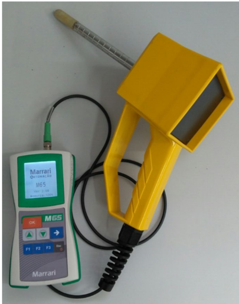
Figura 1 – Teclado, Display, Sensor
