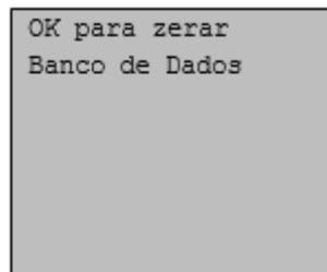
Utilizado para Apagar o Banco de Dados armazenado no medidor.
