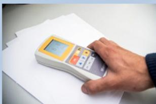
O M71 é um medidor portátil multiuso de umidade e pode ser usado para materiais diversos com superfícies planas: papéis, painéis de madeira, mantas e outros materiais orgânicos. A
