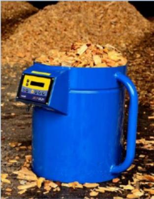
M75 es un medidor de humedad portátil para materiales orgánicos granulados. A demás de la posibilidad de medir la humedad del material, el equipo estima el poder calorífico útil de la muestra. La medición es realizada a través del método dieléctrico.
