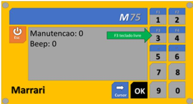
Habilita la operación del sistema en el modo de Mantenimiento. Este recurso debe ser usado únicamente por el equipo de mantenimiento de Marrari.
