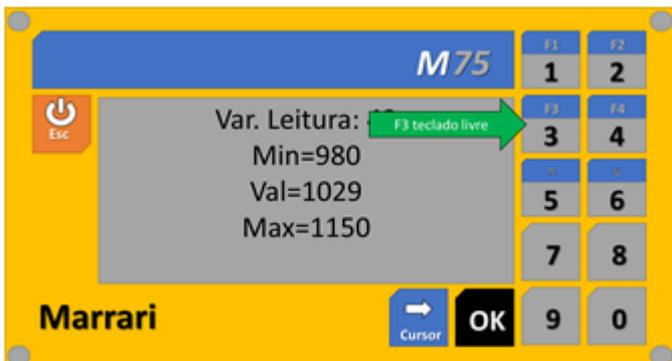
Esta pantalla muestra un contador de la variación en la lectura primaria del sensor en bits.
