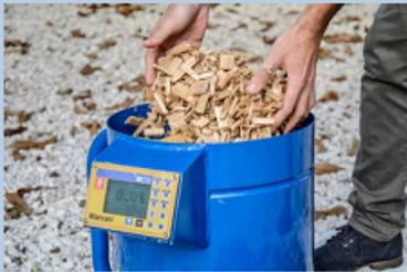
O M75 é um medidor portátil de umidade para materiais orgânicos granulados. Além de medir a umidade do material, o equipamento estima também o poder calorífico útil da amostra. A medição é realizada através do método dielétrico.
