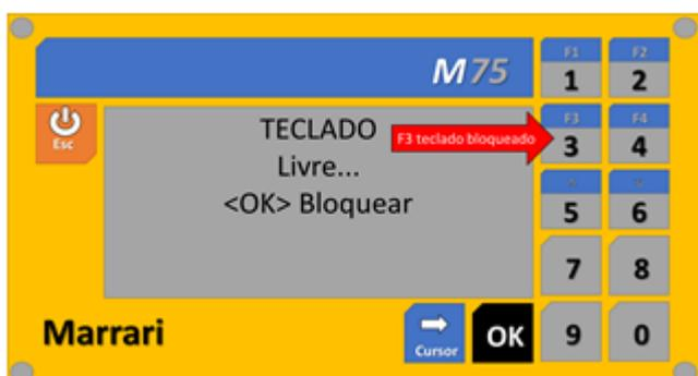
Tela utilizada para liberar o teclado para alteração dos ajustes de leitura. Após 5 minutos sem manuseio do teclado, ele volta para "Bloqueado ...". Pressione "OK" por 2 seg. para mudar o status.
