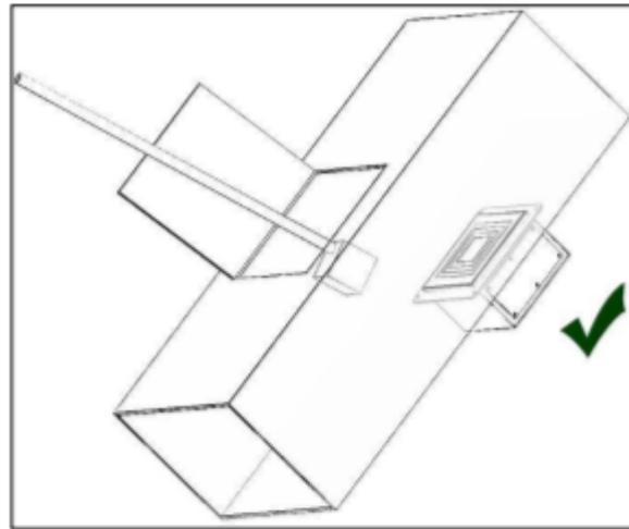
O local de instalação deve permitir acesso visual ao sensor e área para coleta de amostra do material.
