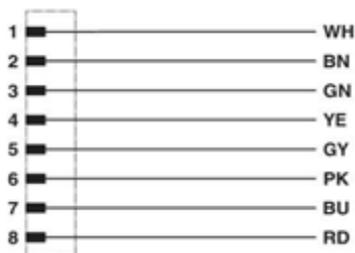
A conexão conector M12-8 pinos macho (cabo):
