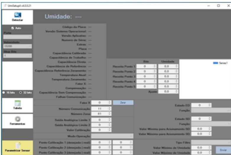
Com o cabo USB conectado ao computador, a primeira ação, é “Detectar” o sensor:
