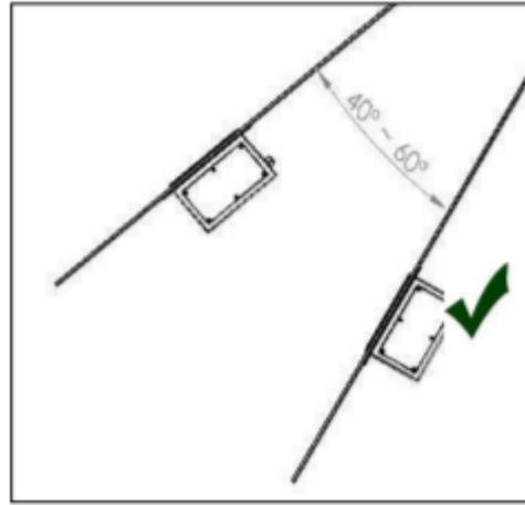
Evitar impacto direto do material sobre o sensor. Ângulo de posicionamento para escoamento do material 40°~60°.
