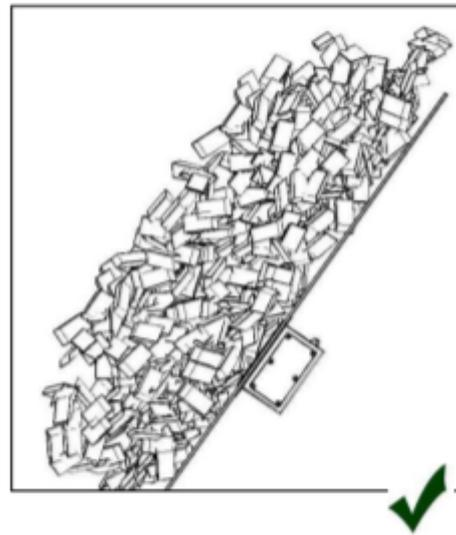
Superfície mínima de material sobre o sensor 70 mm.
