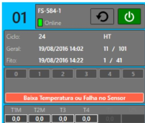
O alarme de coleta fito atrasada ocorrerá quando as coletas terminarem antes do processo terminar:
